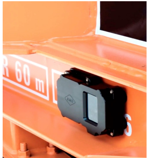
RMD:s PMU monteras på den fjädrade massan
