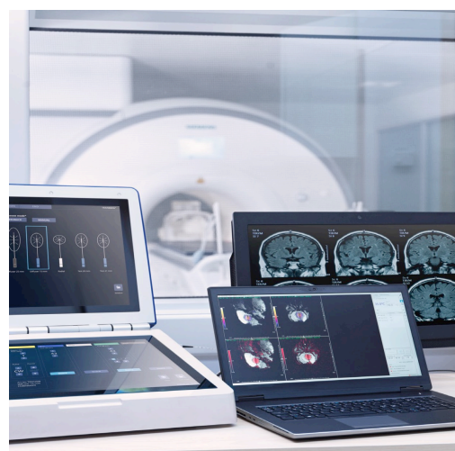
Bild 1: Bilden visar TRANBERG® Mobile Laser Unit med Thermoguide™ Workstation, de enheter som bildar kärnan i TRANBERG® Thermal Therapy System för MR-bildledd laserablation.
